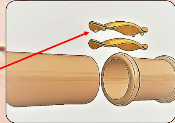
Fixez 2 elastique de 55 mm. Un sur l'embout buccal et un sur le récepteur. Fixez ensuite le lefreQue de 76 mm ou 106 mm.
